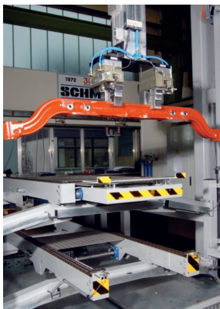
3 Zum Ablegen auf das Abföhrband vorbereitetes Greifermodul mit fertig bearbeiteter Achse; darunter das Zuföhrband für die Rohteile
