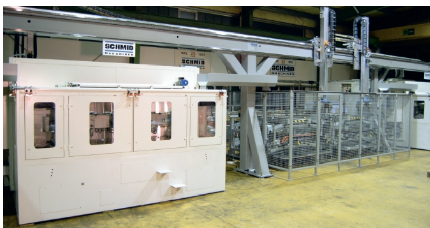
1 Ansicht der Gesamtanlage: Links eines der beiden Bearbeitungszentren, daneben die Zu- und Abfuhrbänder (hinter dem Schutzzaun) für die beiden Bearbeitungszentren; darüber das Linienportal mit den Greifermodulen für die Roh- und Fertigteile zur automatischen Beladung
